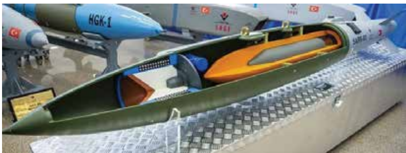
Figura N°3.6 Maqueta de bomba de aviación con carga hueca y ojivas punzantes SARB 83 fabricada en Turquía.
