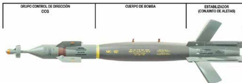
Figura N°8.11 Ubicación de la CCG y el conjunto de aletas
