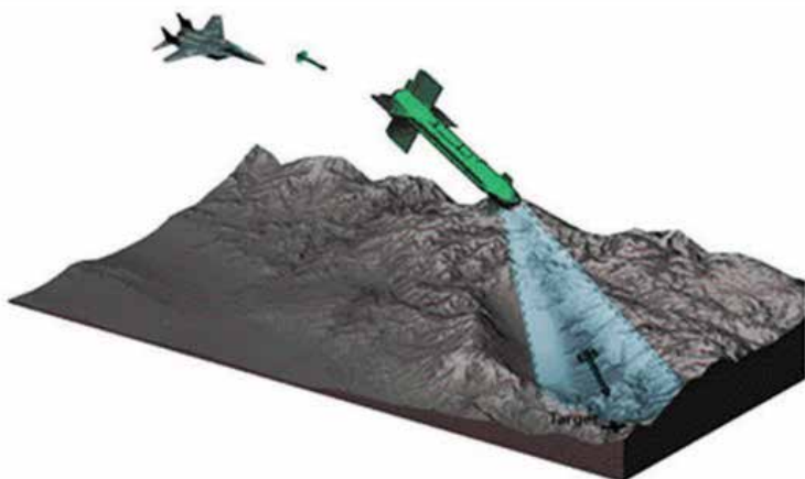
Figura N°8.18 Esquema de funcionamiento de una bomba guiada por televisión.
