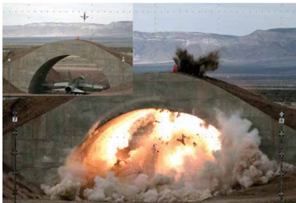
Figura N°3.4 Penetración de un refugio de aeronaves con una bomba GBU-39 (Small Diameter Bomb)
