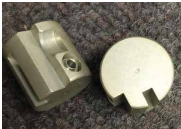
Figura N°7.9 Delay que se utiliza en una espoleta M 904 o M905
