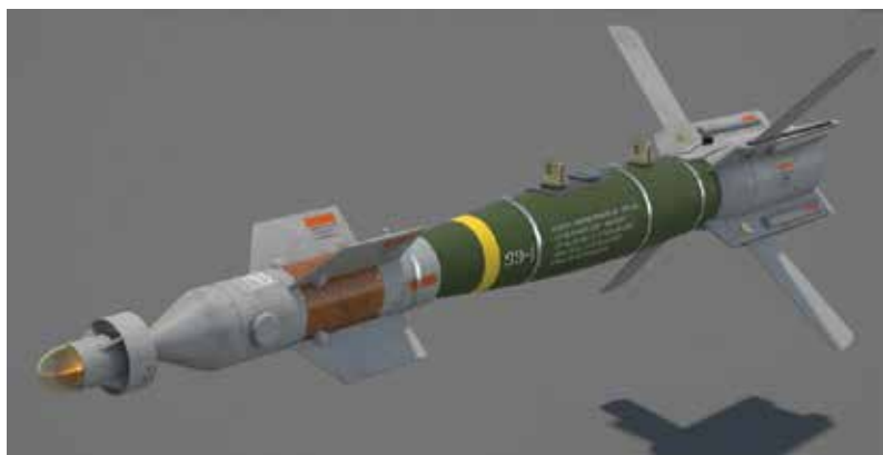
Figura N°5.4 Estabilizador de aleta desplegable y aletas móviles de un kit de guiado láserico en una bomba de aviación
