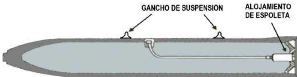
Figura N°2.6 Interior de una bomba de aviación de penetración del tipo BLU.
