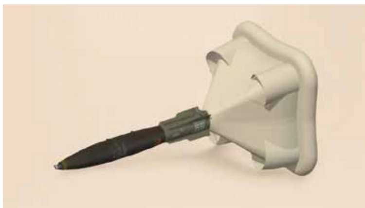
Figura N°5.3 Lustración de un estabilizador con el globo inflado
