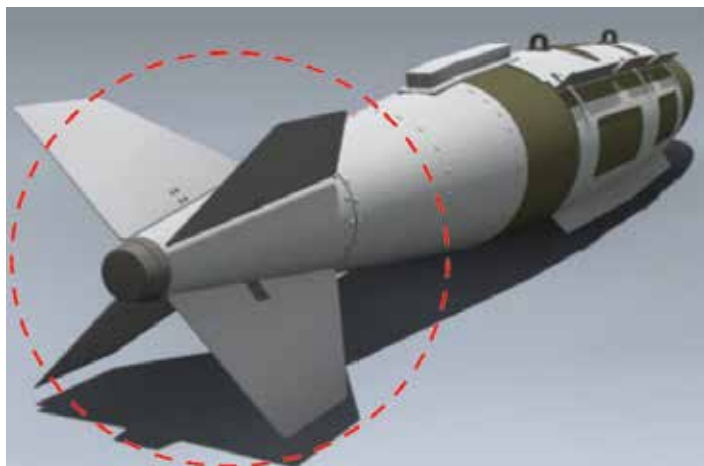
Figura N°5.6 Aletas móviles de un estabilizador de una bomba de aviación de guiado por GPS
