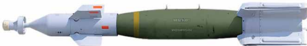
Figura N°8.2 Cuerpo de bomba de aviación tipo MK-82 con kit de guiado láserico Paveway II instalado
