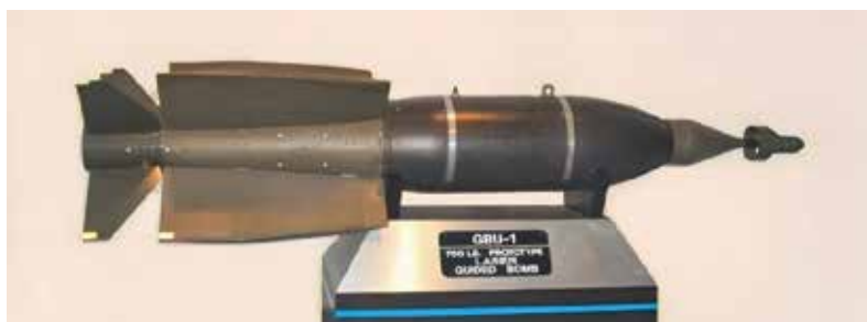
Figura N°1.14 GBU-1, prototipo de un kit de guiado lasérico con una bomba de aviación modelo M117 (750 lbs)
