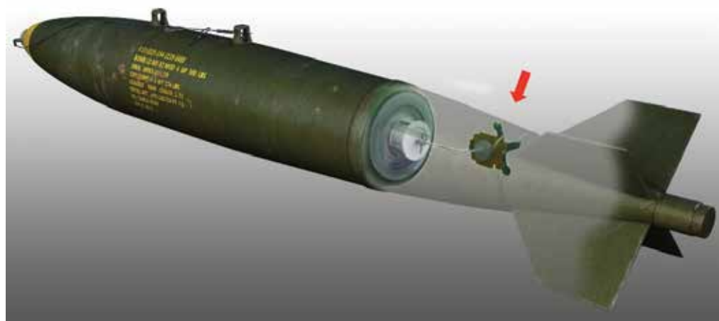
Figura N°7.5 Veleta en una bomba de propósito general MK-82
