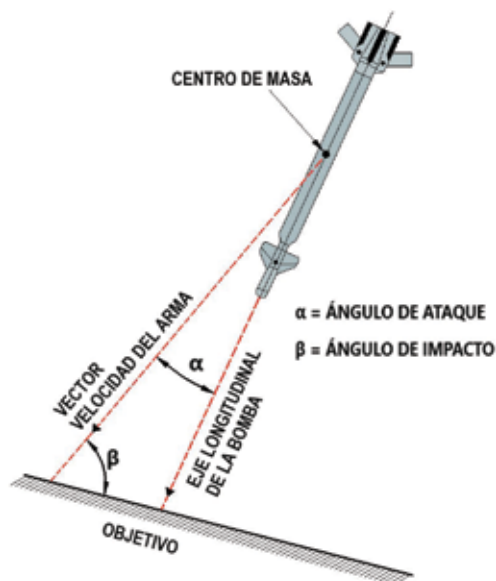
Figura N°3.3 Ángulos de Ataque e Impacto de una bomba contra el terreno
