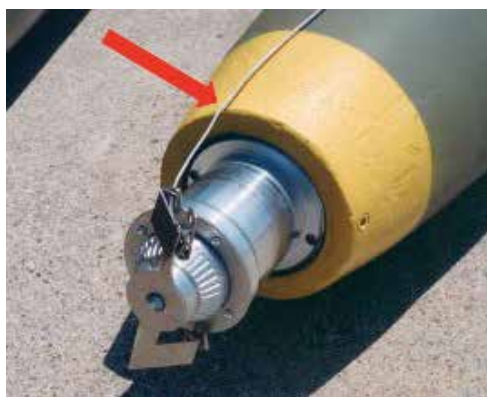
Figura N°7.2 Alambre asegurando la espoleta de nariz de la bomba
