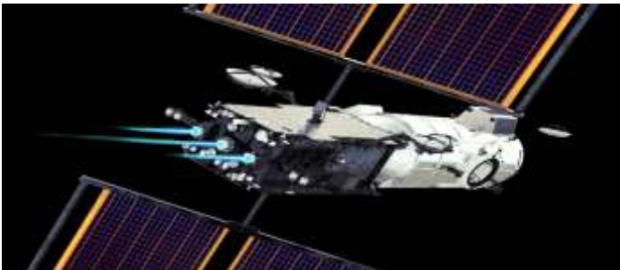
Detalle del PPE de Gateway con el módulo HALO acoplado con 3 motores de 12 kW y cuatro de 6 kW (NASA).
