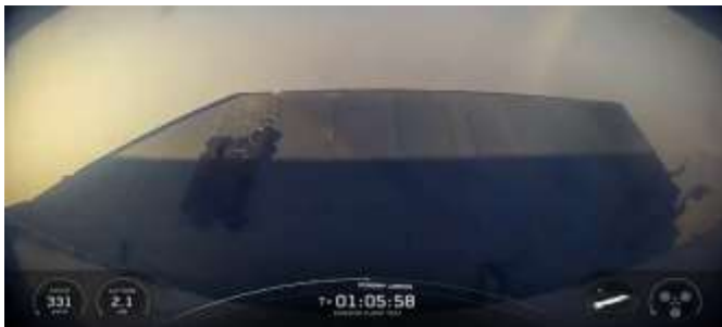
Superficie de control dañadas (SpaceX)
