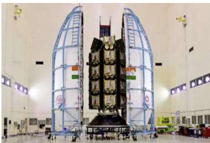
El dispensador utilizado para depositar todos los satélites OneWeb fabricados por Beyond Gravity (Crédito de la imagen: ISRO, OneWeb)
