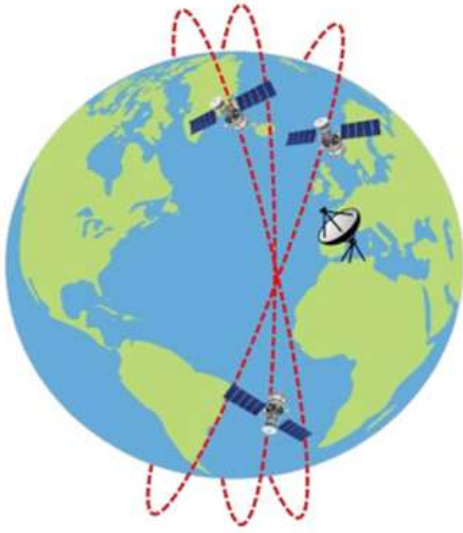
Configuración orbital Walker-Star de los satélites OneWeb (Crédito de la imagen: Moon et al., 2024)
