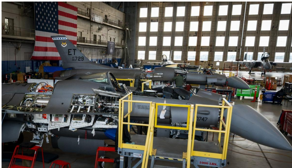
F-16 siendo modificados como parte del programa VENOM en la Base de la Fuerza Aérea Eglin, Florida. Las modificaciones incluyen cambios de software, hardware e instrumentación que permitirán a las aeronaves volar de manera autónoma.
