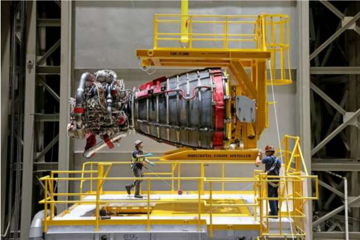
Los técnicos en la Instalación de Ensamblaje Michoud de la NASA en Nueva Orleans trabajan para colocar el primero de los cuatro motores RS-25 en la etapa central del cohete SLS (Space Launch System) para la misión Artemis I de la agencia a la Luna.
