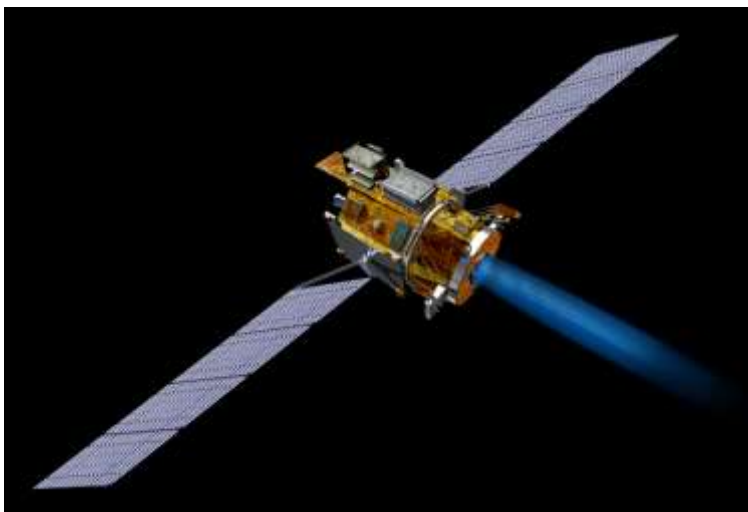
Vista artística de Deep Space 1 que muestra los paneles solares y el motor de iones (con escape azul), aspectos principales de este diseño eléctrico solar.
