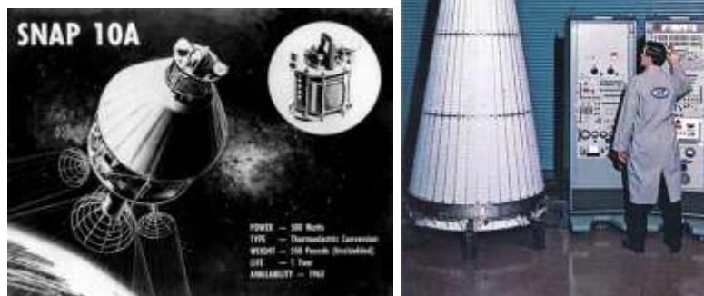
El SNAP 10-A. En el extremo más cercano de la imagen se aprecia el reactor y el conjunto de radiadores.
