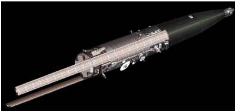
Imagen de un RORSAT. A la izquierda se pueden apreciar las antenas del sistema de radar.
