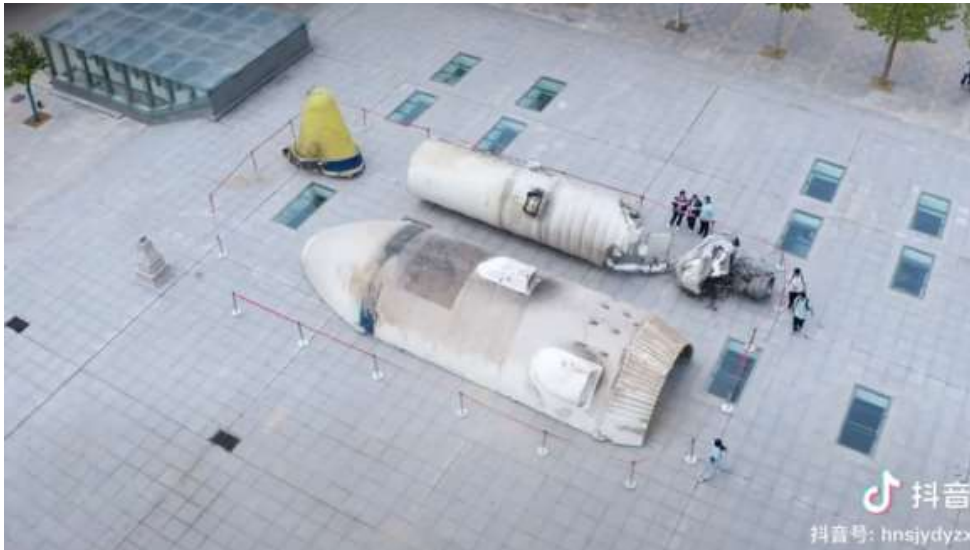
Restos de la cofia del CZ-2F que lanzó el avión orbital chino. Se aprecian las protuberancias exteriores que podrían servir para albergar las puntas de las superficies aerodinámicas (TikTok: @hnsjdyzx).
