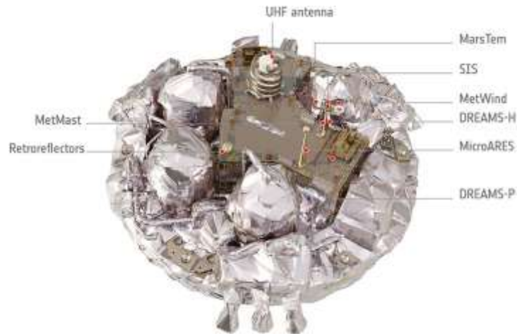
Plataforma de amortiguación Schiaparelli y sus cargas útiles. Crédito: ESA.
