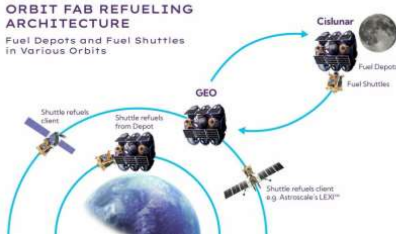
Esquema de cómo funcionan los servicios de reabastecimiento. (Orbit fab)
