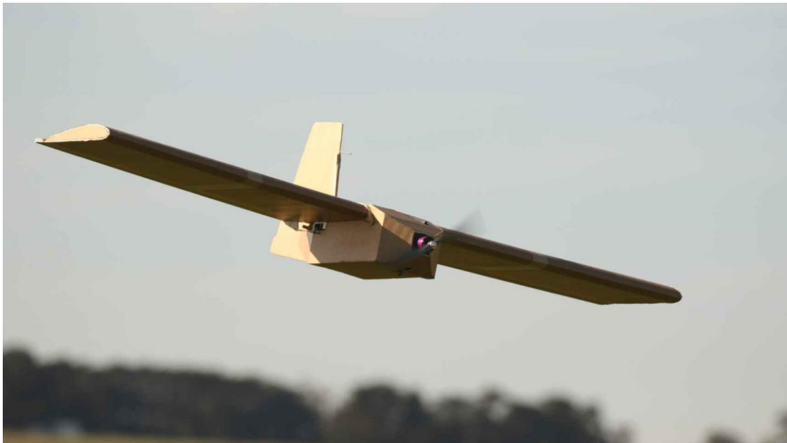
Drone Corvo PPS SYPAQ, cuya estructura es de cartón. Fuente: El Español.com
