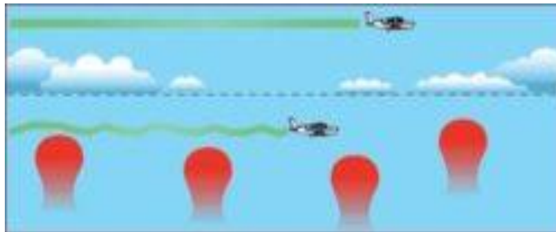
Fig 3: Esquema Turbulencia térmica.
