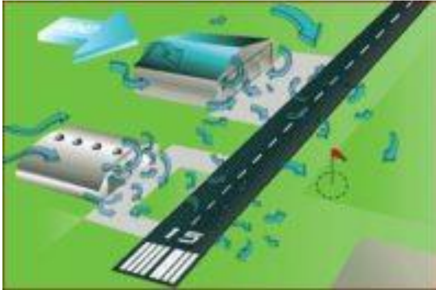
Fig 2: Esquema turbulencia mecánica.
