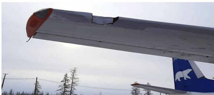
Daños en el ala derecha del Antonov An-24RV de Polar Airlines tras golpear el poste de electricidad.
