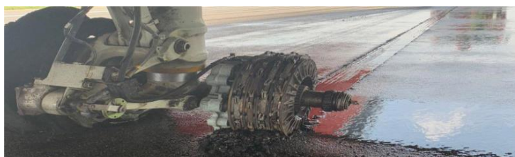
Discos de freno y rueda reventada del tren de aterrizaje del Boeing 737 de Max Air.
